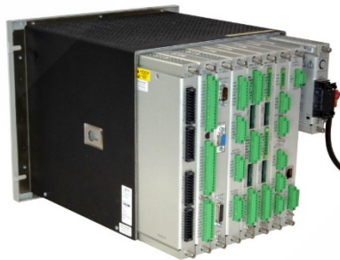
Figure 4: Mini Rack Back View - I/O Modules
