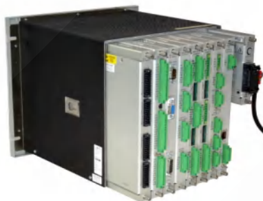
Figure 4: Mini Rack Back View - I/O Modules
